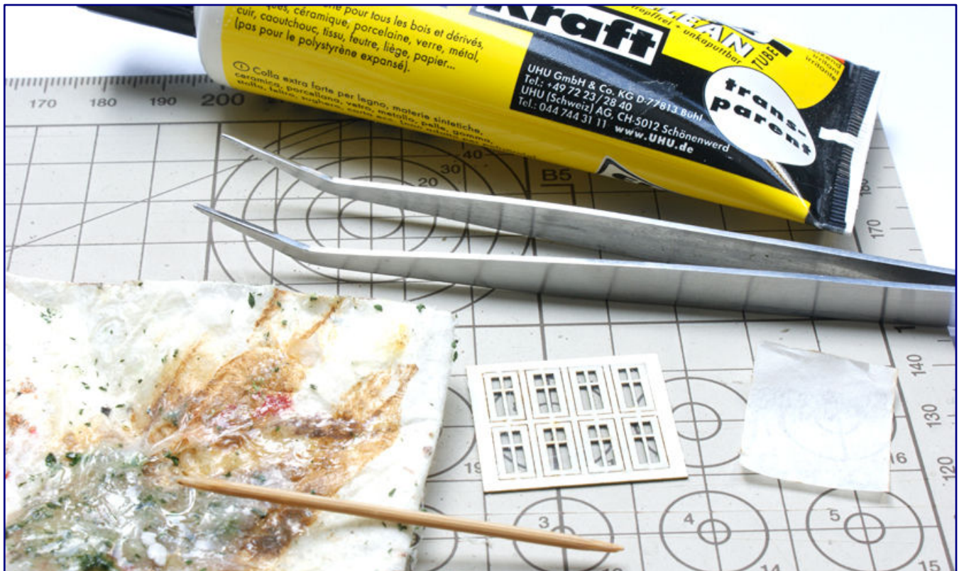
Die selbstklebende Folie bewährt sich bei unserem Zusammenbau nicht. Wir greifen zur gewohnten Methode und kleben sie mit Uhu Kraft, den wir mit Hilfe der Zahnstocherspitze dünn in den Fensterecken verteilen.
